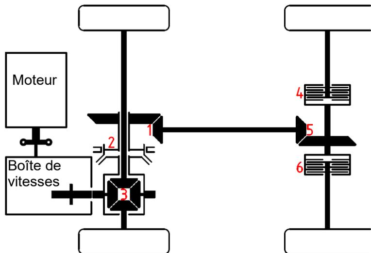
Les composants 2, 4 et 6 sont fermés. Indiquer les taux de blocage correspondants en % conformément au schéma.
