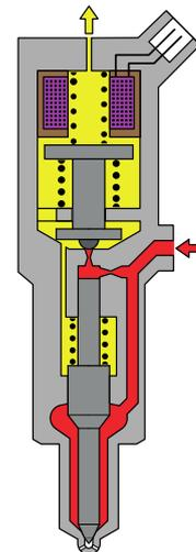
L'électrovanne est commandée, l'étranglement d'écoulement se ferme, le carburant coule, la pression dans la chambre de commande d'injecteur augmente, la pression dans le volume de la chambre est inférieure à celle dans la chambre de commande d'injecteur, le piston de commande d'injecteur redescend, l'injecteur s'ouvre.
