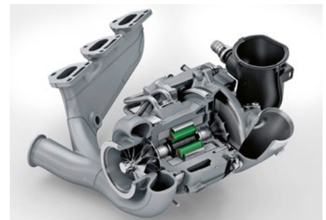
Comme en Formule 1: un rotor à entraînement électrique ou conçu comme système de récupération alimente tous les cylindres en air pré-comprimé grâce à une roue de turbine et de compresseur dont le diamètre ne mesure plus 50 mais 80 mm. Au lieu de laisser passer les gaz d'échappement à la limite de la pression de suralimentation au moyen d'un clapet de dérivation, la roue de la turbine peut entraîner la machine électrique. Photo: Porsche
