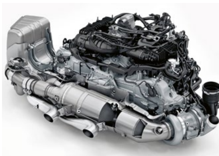
Ce qui frappe sur le nouveau moteur GTS six cylindres à plat, c'est qu'il ne comporte plus qu'un seul turbocompresseur à gaz d'échappement sur le côté droit du véhicule (au lieu de deux comme sur toutes les autres variantes). Non seulement une machine électrique est utilisée entre le moteur à combustion et la boîte à double embrayage à huit vitesses, mais aussi, pour la première fois, un turbocompresseur à gaz d'échappement avec entraînement/récupération électrique. Photo: Porsche
