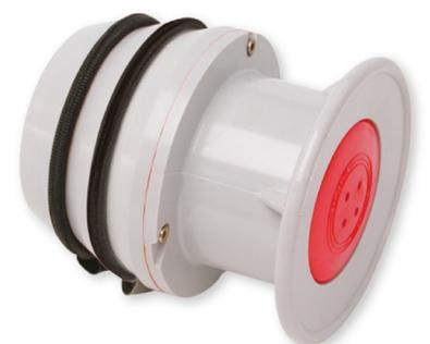
La verifica della tenuta dei guanti ad alto voltaggio deve essere effettuata prima di ogni utilizzo, utilizzando una pompa a mano (vedi immagine) oppure ribaltando il guanto dalla parte del braccio (prima sigillare e poi creare pressione) per rilevare eventuali danni.
