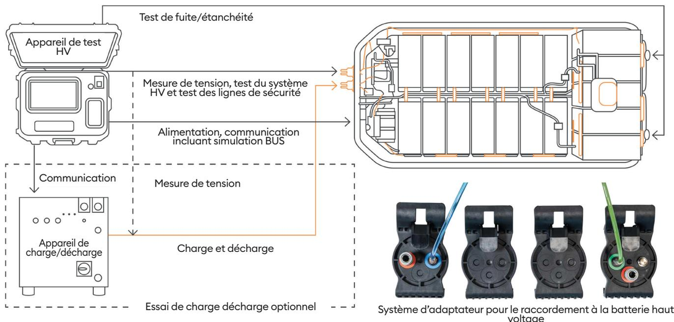
L'étanchéité de la batterie haute tension ou d'autres composants est déterminée par des tests de surpression ou de dépression. L'appareil de test est généralement connecté aux raccords du liquide de refroidissement à l'aide d'un adaptateur et l'étanchéité du système est vérifiée en fonction du temps d'attente.
