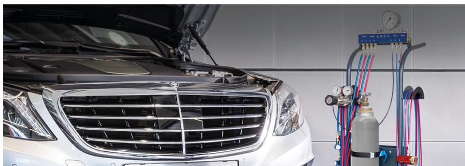
Il existe également des options de test pour les batteries HV refroidies par climatisation. Avant l'installation, l'étanchéité de l'évaporateur de la batterie est vérifiée à l'aide d'un gaz test.
