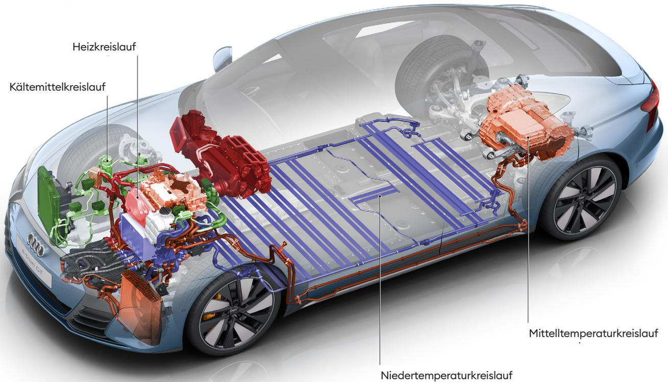
Die Hochvoltbatterie wird im Niedertemperaturkreislauf gekühlt. Geheizt wird mittels PTC-Widerstand, gekühlt via Klimaanlage und Chiller.
