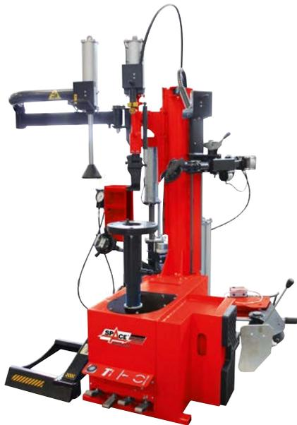
26 pouces de diamètre de jante et d'une largeur de jante pouvant aller jusqu'à 15 pouces s'est imposée. La machine ergonomique séduit par ses éléments innovants qui facilitent et accélèrent notamment le traitement des pneus taille basse (UHP) ou autoporteurs (RFT).
