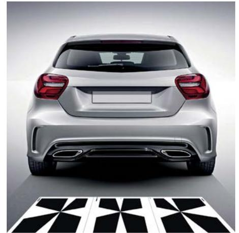
prennent de plus en plus d'importance. C'est pourquoi **Texa** a développé le « **kit d'étalonnage de caméra de véhicule** » qui se compose de plusieurs tableaux d'étalonnage spécifiques à une marque et qui permet, associé à un appareil de diagnostic, un étalonnage correct des capteurs faisant partie du système d'assistance à la conduite.
